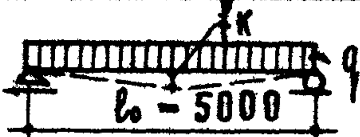
СХЕМА ВПРЯЖЕНИЯ И ЗАГРУЖЕНИЯ ПРИ ИСПЫТАНИИ (ПЛОЩАДЬ ЗАГРУЖ. 50x146М)
